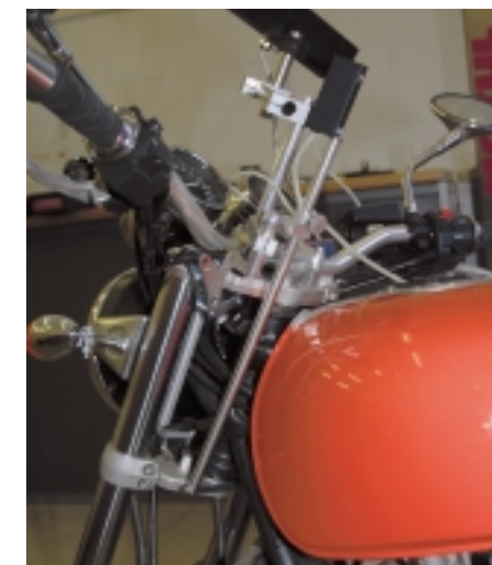
Über die Kameras erfasst die Software die Infrarotpunkte der Zielmarke. und errechnet eine Kreisbahn um die Lenkachse (oben). Der kleine Zielkörper für die Aufbauhöhe wird am Ende des Lenkkopfes angesetzt (unten).
