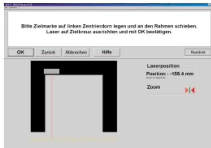
Mit Hilfe des verschiebbaren Lasers werden die Ansatzpunkte des Bügels markiert. Die Software errechnet daraus die Mittelachse des Fahrzeuges, die es etwa für die Messung des Lenkkopfersatzes benötigt.
