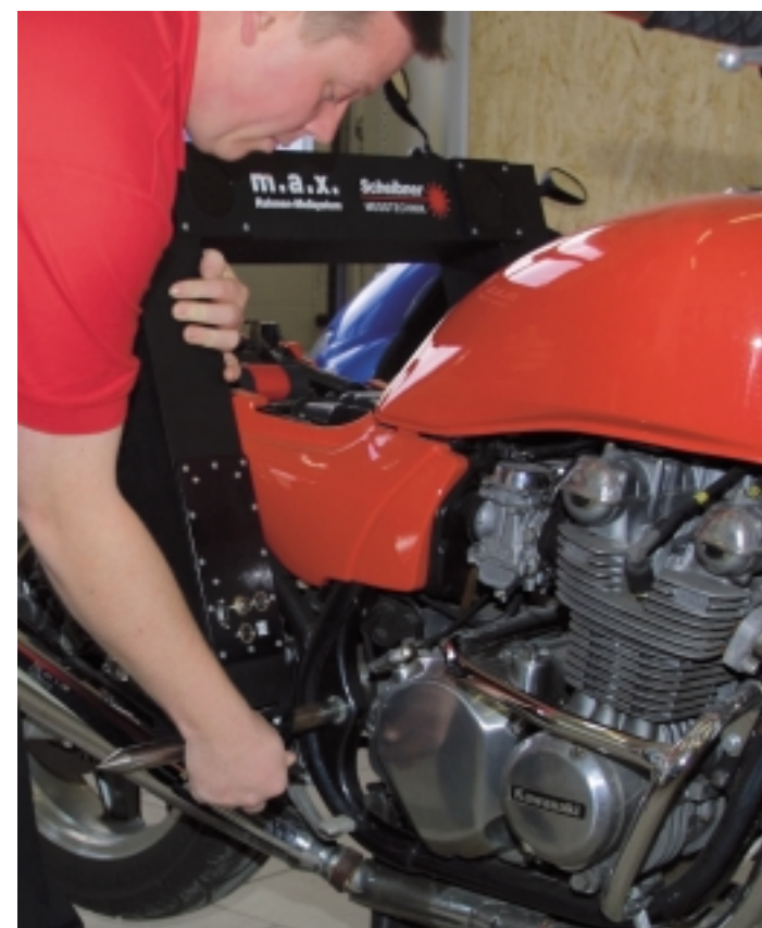
Zur Montage des M.A.X.-Systems muß man bei den meisten Motorrädern nur die Sitzbank entfernt werden. Das spart Zeit und Kosten.
