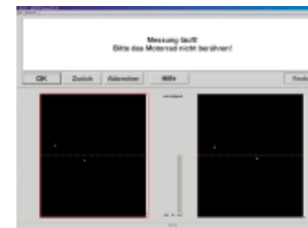
Über die Kameras erfasst die Software die Infrarotpunkte der Zielmarke. und errechnet eine Kreisbahn um die Lenkachse (oben). Der kleine Zielkörper für die Aufbauhöhe wird am Ende des Lenkkopfes angesetzt (unten).
