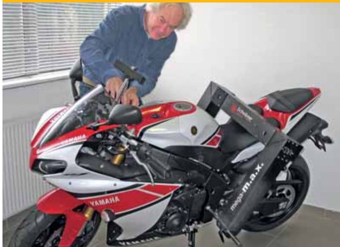
Doorgaans is alleen de zitting verwijderen al voldoende om het Mega-m.a.x. juk met camera's te kunnen plaatsen. Dan nog de doelen op het balhoofd bevestigen, en meten maar.
